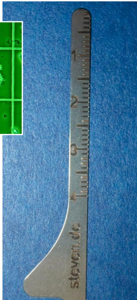
Abb. 4: Markierung eines Fornixlineals zum Einsatz in der Augenheilkunde. Dieses nur wenige 100 µm dicke Blättchen einer Titanlegierung darf nur geringer thermischer Erwärmung ausgesetzt werden, um die Rückseite nicht zu verbrennen. Daher wurde, der in Millimetern skalierte Maßstab durch „Kaltablation“ mit einem Excimerlaser eingebracht.
